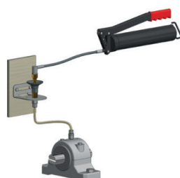
Nel montaggio indiretto preriempire il punto di lubrificazione e le condutture flessibili (utilizzare lo stesso lubrificante del sistema di lubrificazione)
