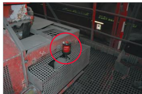
Lubrificazione di un cuscinetto di supporto su un impianto a nastro trasportatore
