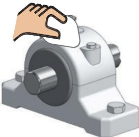
Nettoyage du point de graissage
