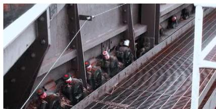
Lubrification des paliers sur les systèmes de triage d'arbres
