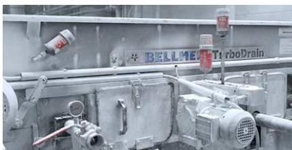
Lubrification de palier d'une presse à bandes
