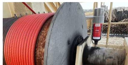
Lubrification des roulements à rouleaux de grue
