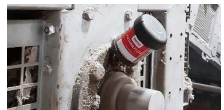
Lubrificazione di un cuscinetto di supporto su un impianto a nastro trasportatore
