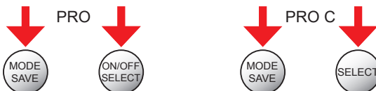
Figura 13 Premere verso il basso entrambi i pulsanti del lubrificatore contemporaneamente > 4 s.
