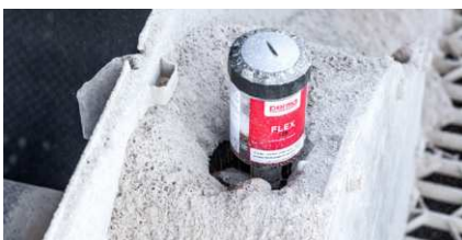
Lubrification du palier d'un dessableur & crible
