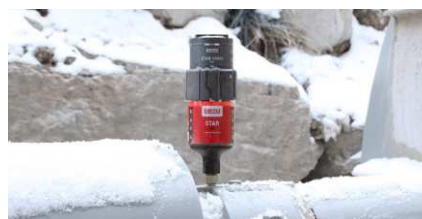
Lubrification de palier et de garniture d'un ventilateur
