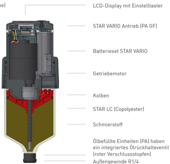
\*Um die Funktion für Temperaturen unter -20 °C sicherzustellen, muss das Batterieset STAR VARIO Tieftemperatur (Lithium) verwendet werden.
