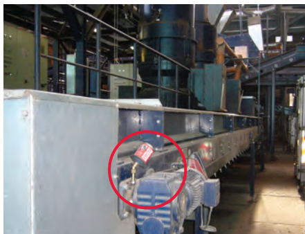
Lubrification du palier de pivotement d'un convoyeur
