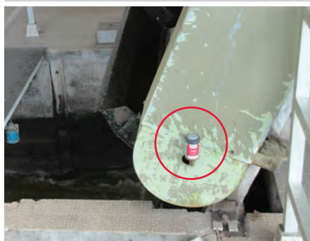
Lubrification de palier à roulement sur le galet de guidage de chaîne
