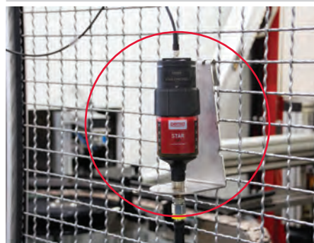
Lubrification automatique d'un guidage à glissement
