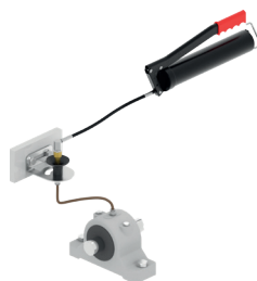
Para montaje a distancia, rellenar previamente los tubos y el punto de lubricación (usar el mismo lubricante que en el sistema de lubricación)
