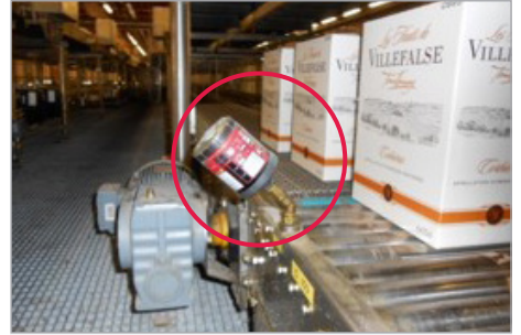
Schmierung einer Kette in einer Förderstrecke
