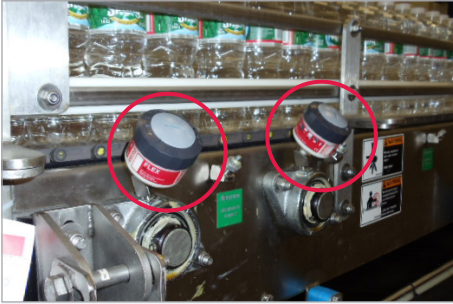
Schmierung eines Förderbandflansch- lagers an einer Abfüllanlage
