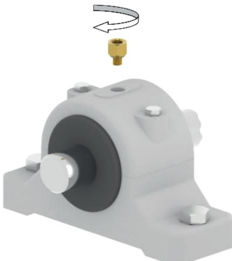
4. Schmierstelle mit allen Anbauteilen und Schlauchleitungen vorschmieren. Alle Anbauteile und Schläuche müssen vorgefüllt werden, damit der Schmierstoff sofort die Schmierstelle erreicht.
