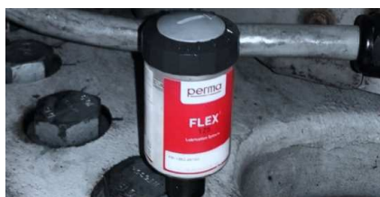
Lubrificazione dei denti del cuscinetto delle pale
