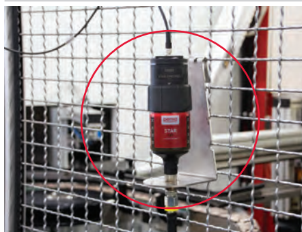
Lubrificação automática de uma guia deslizante
