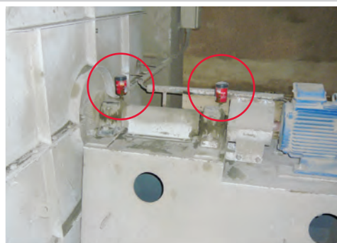
Lubrificação de mancais de um eixo do exaustor eixo de acionamento de exaustor
