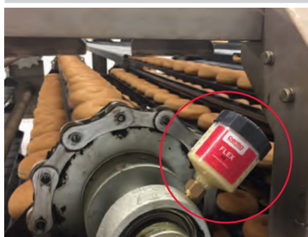
Lubrificação de mancais numa secção de arrefecimento para produtos de panificação
