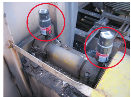
Lubrificação de um rolamento do eixo de exaustor
