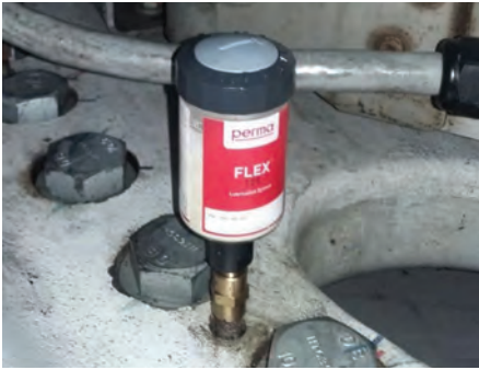
Lubrificação de dentes de engrenagem de azimute
