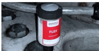
Lubrificazione dei denti del cuscinetto delle pale
