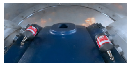
Lubrificazione del cuscinetto delle pale
