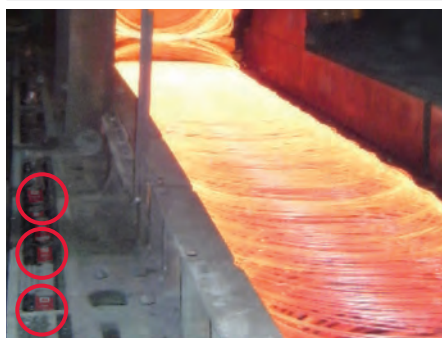
Lubrificazione di catene di comando (alimentatore spiralatrice)
