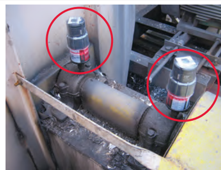
Lubrificazione dei supporti dell'albero del ventilatore
