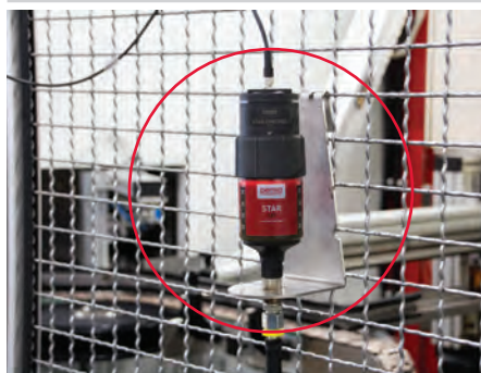
Lubrificazione automatica di una guida di scorrimento
