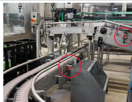
Lubrificazione catene dopo il confezionamento e il controllo delle scatole piene
