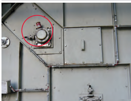
Lubrificazione di un cuscinetto a flangia su un nastro trasportatore a tazze
