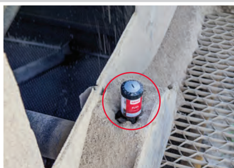
Lubrificazione del cuscinetto su vagli per graniglia e sabbia
