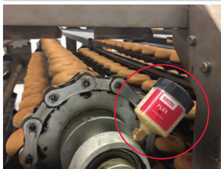
Lubrificazione di un cuscinetto sulla linea di raffreddamento per prodotti di panetteria
