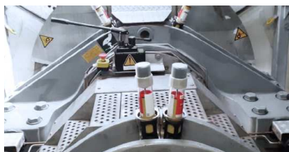
Lubricación de los cojinetes principales
