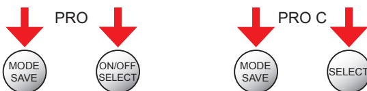
Figura 10 Per un'erogazione supplementare premere contemporaneamente entrambi i pulsanti del lubrificatore e mantenerli premuti.
