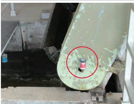
Smarowanie łożysk tocznych na rolce prowadzącej łańcucha
