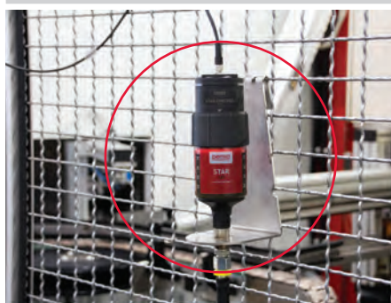
Automatyczne smarowanie prowadnicy ślizgowej
