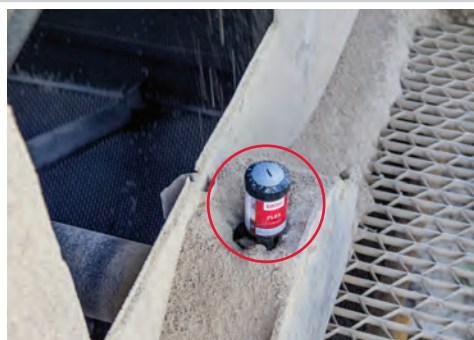
Smarowanie łożysk ślizgowych dzielonych przesiewaczy odtłmków i piasku
