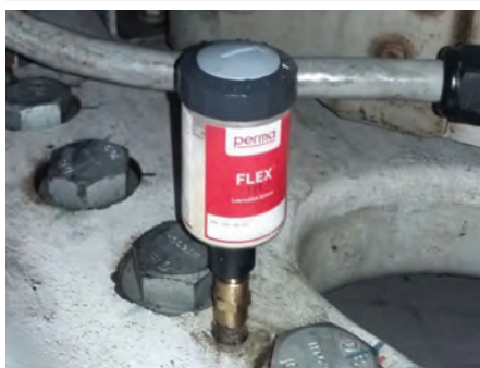
Smarowanie uzębienia naprowadzania
