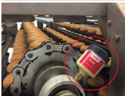
Smarowanie łożysk ślizgowych dzielonych w module chłodzenia pieczywa
