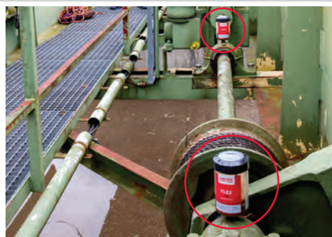
Smarowanie łożysk tocznych na skrobaku
