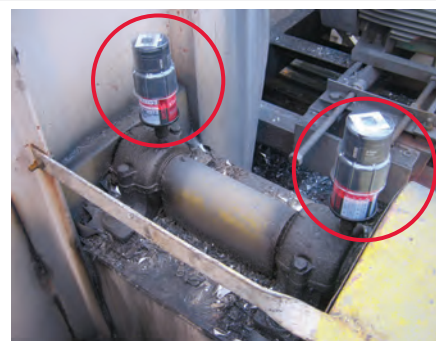
Smarowanie łożyskowania wału wentylatora
