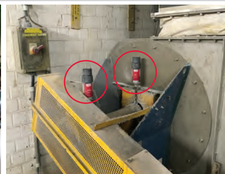
Smarowanie łożysk wentylatora
