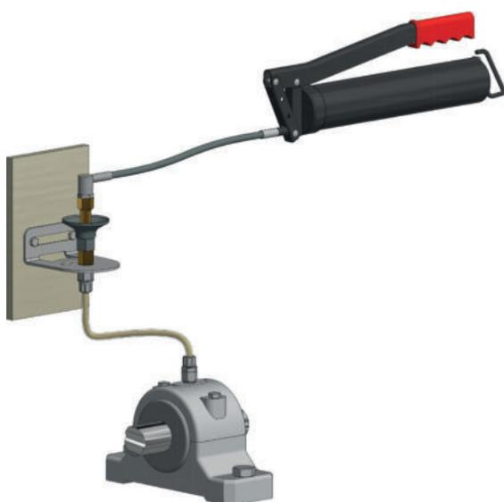
6. Para la prelubricación y el llenado de las mangueras o tubos, use el adaptador de prellenado:
