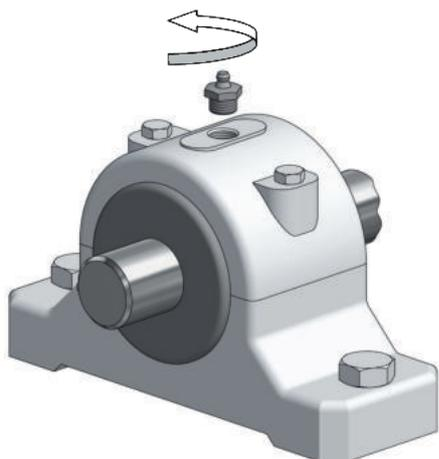
Determine el tamaño de la rosca de empalme en el punto de lubricación perma Placa para determinar roscas
