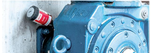
Die Schmierstellen sind mit perma Schmierensystemen ausgerüstet.
