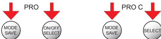
Imagen 11 Para la iniciación manual se mantendrán pulsadas simultáneamente ambas teclas del lubricador.
