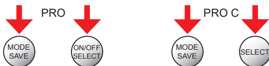
Imagen 10 Mantener pulsados ambos interruptores del lubricador para realizar una lubricación especial.
