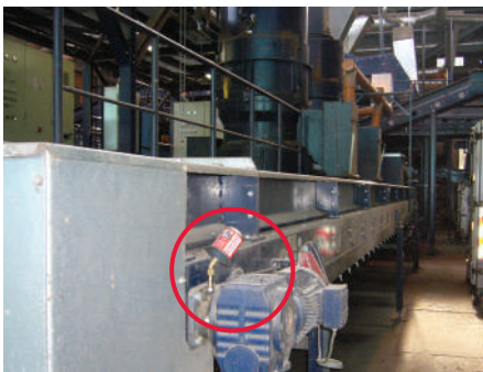
输送机法兰轴承的润滑
