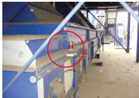
输送机法兰轴承的润滑
