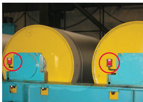
热镀锌生产线中滚柱轴承的润滑
