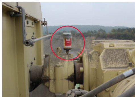
高温垂直斗式输送机上滚柱轴承的润滑
