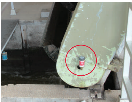
链导辊滚柱轴承的润滑
