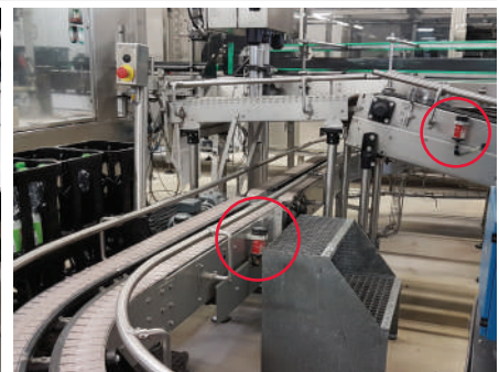
包装机和全面箱体检查之后包装盒运输系统链条的润滑
