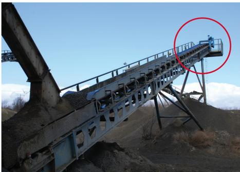
Oftmals befinden sich Schmierstellen an schwer zugänglichen Orten für Mitarbeiter. Wartungsarbeiten sind so nur bei stehender Anlage möglich. Dennoch ist die Schmierung von Anlagen notwendig, um Stillstandszeiten zu minimieren.
