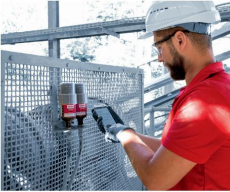
Schmierstellen außerhalb des Gefahrenbereichs, ermöglichen eine gefahrlose Durchführung von Wartungsarbeiten.
