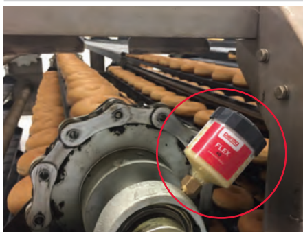
Stehlagerschmierung an einer Kühlstrecke für Backwaren
