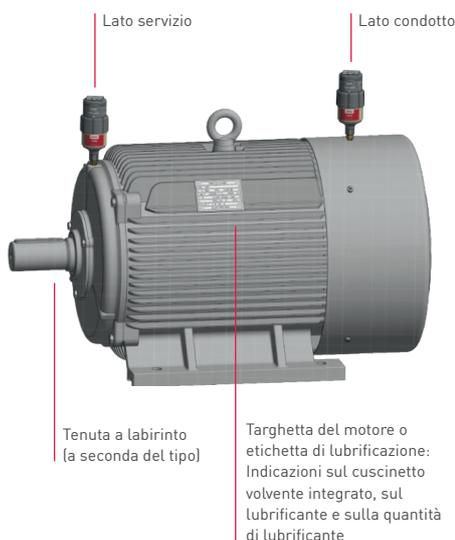
I punti di lubrificazione si trovano sul lato servizio e sul lato condotto dei motori elettrici. In caso di rilubrificazione occorre fare attenzione alla fuoriuscita del grasso esausto da aperture, tenute a labirinto o camere di grasso esausto. L'assenza di punti di sfogo o il riempimento eccessivo delle camere del grasso esausto determinano il surriscaldamento dei cuscinetti.
