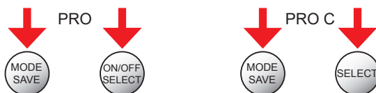
Figure 10 Graissage supplémentaire: appuyer de manière prolongée sur les deux touches de l'unité d'entraînement.
