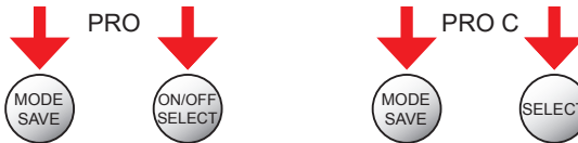
Figure 11 Initialisation manuelle: maintenir enfoncées les deux touches de l'unité d'entraînement
