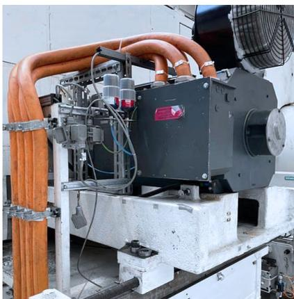
Schmierung eines Elektromotors an einer Presse
