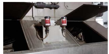
Lubrificazione del cuscinetto sull'addensatore dei fanghi
