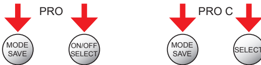
Bild 11 Zur manuellen Initialisierung beide Tasten des Schmierstoffgebers gleichzeitig gedrückt halten.
