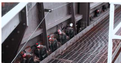
Lubrificazione del cuscinetto sul sistema di selezione ad albero
