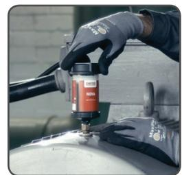
Instale el **sistema de lubricación** en la aplicación.
