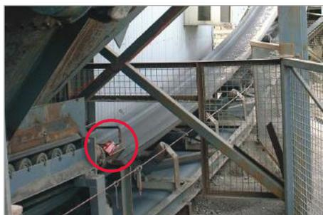
Lubrificazione di un cuscinetto di supporto su una bilancia a nastro trasportatore
