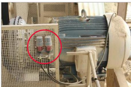
Lubrificazione a distanza di un motore elettrico
