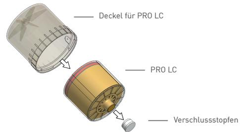
Setzen Sie die PRO LC in den Deckel ein und entfernen Sie die Verschlussstopfen der PRO LC.
