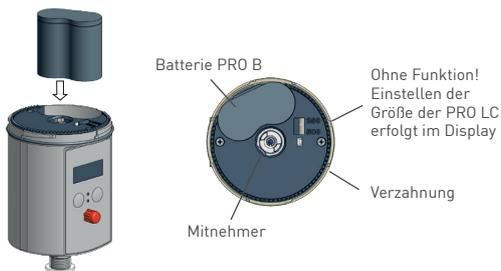
Setzen Sie die Batterie PRO B (Pfeilrichtung beachten) in das Antriebssystem ein.
