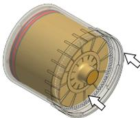
Drücken Sie die PRO LC in den Deckel bis Schmierstoff aus der Auslassöffnung austritt.
