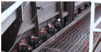
Lagerschmierung an der Baumsortierung
