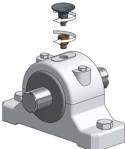
4. Prelubricar el punto de lubricación, todas las conexiones y tubos flexibles. Rellenar las mangueras y piezas de conexión con el lubricante adecuado previamente a fin de que éste llegue rápidamente al punto de lubricación.
