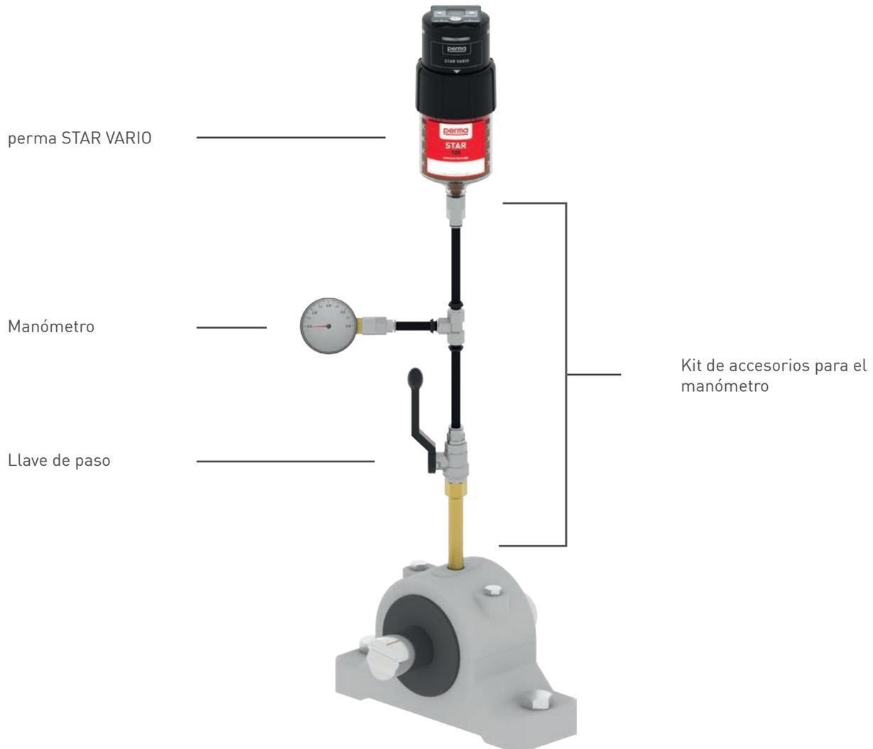
Para la prueba de presión puede usar perma STAR VARIO en combinación con el kit de accesorios para el manómetro (101480).
