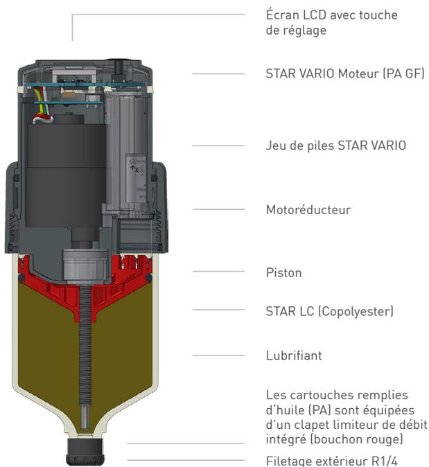
\*Pour assurer le fonctionnement à des températures inférieures à -20 °C, il faut utiliser le jeu de piles STAR VARIO basse température (lithium).
