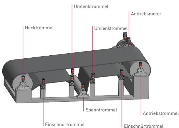
Für die Lagerung der Antriebs- und Umlenktrummeln werden vorwiegend Stehlagergehäuse mit Pendelrollenlagern verwendet.
