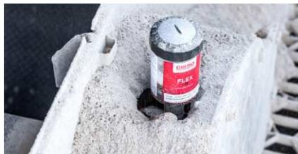
Stehlagerschmierung an Splitt- & Sandsieb
