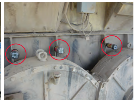
Lubricación de una cinta transportadora
