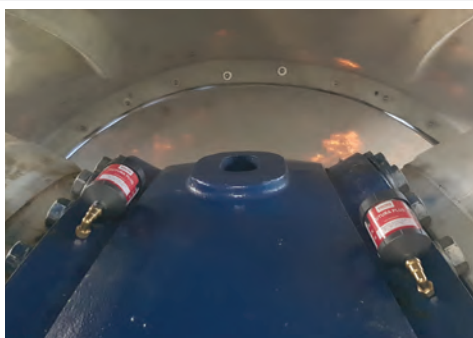
Lubricación del cojinete de aspa
