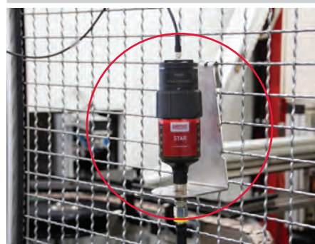
Lubricación automática de una guía de deslizamiento
