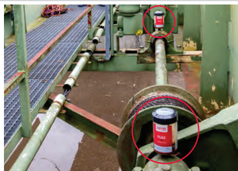
Lubricación de rodamientos en el separador
