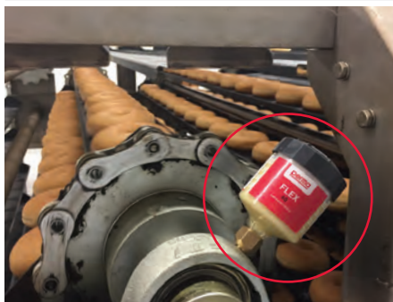
Lubricación del cojinete de soporte en un tramo de enfriamiento para productos horneados
