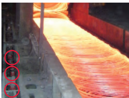
Lubricación de cadenas de accionamiento (transportador de alambre con tornillos)
