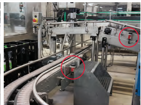
Lubricación de cadena en el transporte de cajas tras la empaquetadora y el control de cajas llenas
