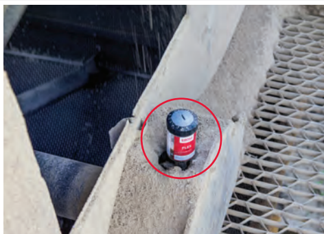
Lubricación del cojinete de soporte en los cribados de arena y de gravilla
