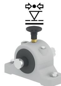
Druckprüfung: Schmierstelle | alle Anschlusssteile
