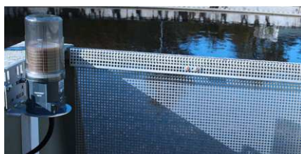
Lubrification de la couronne d'orientation de roulement
