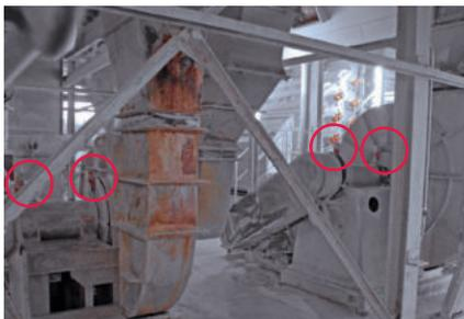
Les ventilateurs sont souvent utilisés dans un environnement dans lequel un **taux très élevé d'impuretés est présent dans l'air**, celles-ci pouvant se déposer sous forme de poussière sur les logements de palier. Si ces impuretés pénètrent dans le logement du palier, cela peut provoquer une défaillance précoce du palier.
