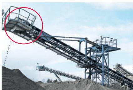
Les convoyeurs de grande taille fonctionnent souvent sur de grandes distances, sur plusieurs niveaux et sont **difficilement accessibles**. La relubrification doit être idéalement effectuée sur l'installation en marche. Les points de lubrification au niveau des points de transfert sont souvent uniquement accessibles par les grilles passerelles ou les plateformes de travail et sont donc **négligés**. **La prévention des accidents et la sécurité au travail** doivent être assurées à tout moment.
