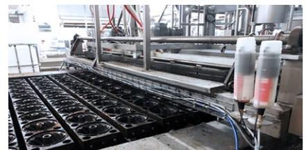
Lubrificazione di una catena del forno in una linea di cottura
