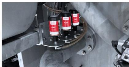
Lubrificazione dei cuscinetti di supporto su una bilancia a nastro con montaggio remoto
