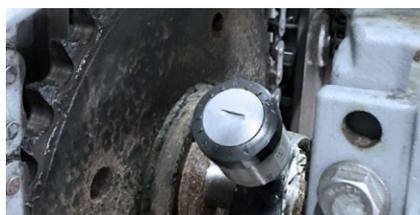
Lubrificazione di un cuscinetto di supporto su un tamburo di azionamento
