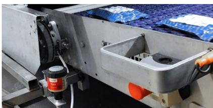
Lubrificazione di un cuscinetto a flangia a un nastro trasportatore tramite montaggio remoto
