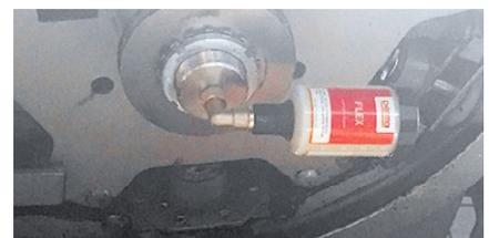
Lubrificazione del cuscinetto a rulli di trasmissione su un forno
