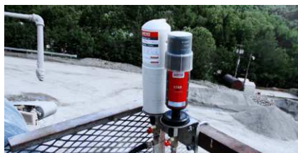
Lubricación del soporte de un rodillo de presión
