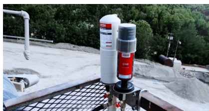
Lubricación del cojinete de soporte de una cinta transportadora
