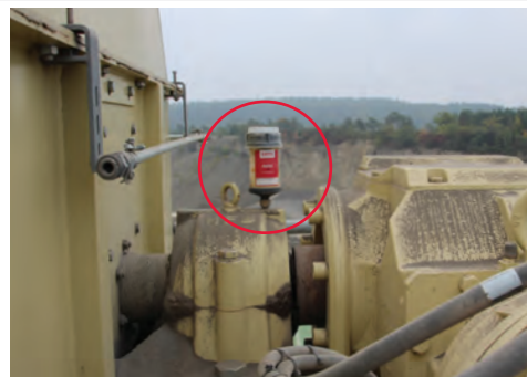
Smering van de wentellagers op de hete elevator
