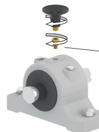
Appliquer un produit d'étanchéité (par ex. Loctite® 243™)
