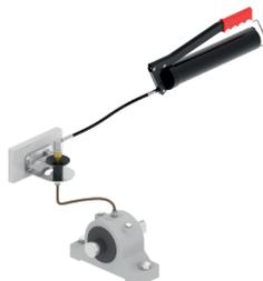
En cas de montage indirect effectuer un pré-remplissage du point de graissage et des flexibles (utiliser le même lubrifiant que dans le système de lubrification)
