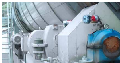
Schmierung der Stehlager an der Trockentrommel
