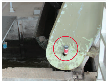
チェーンガイドローラーのローラーベアリングへの給油
