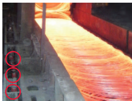
ドライブチェーンへの給油 (ボルトストックコンベヤー)
