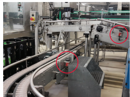
包装とクレート検査を終えたボックスの、搬送チェーンへの給油
