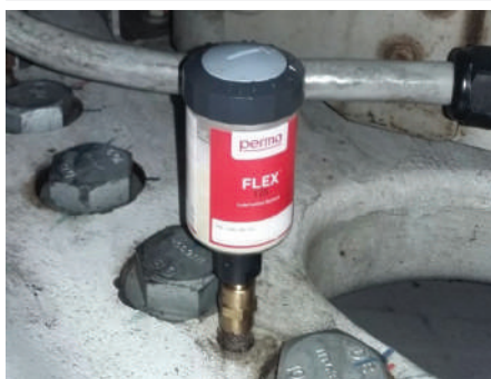
ヨーベアリングへの給油
