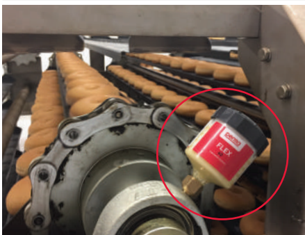
焼成品冷却エリアのピローブロックベアリングへの給油
