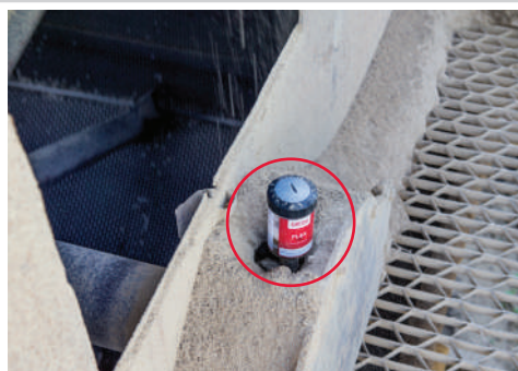
砂ふるい機のピローブロックベアリングへの給油
