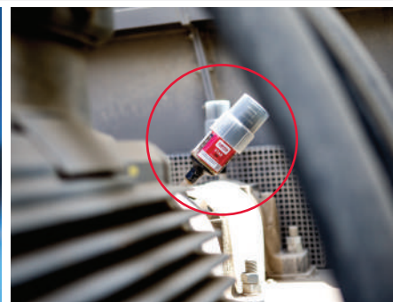
ファンのベアリングへの給油
