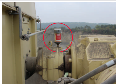
高温の縦型バケットコンベヤーの、ローラーベアリングに設置した給油器
