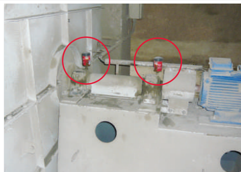
ファンの駆動軸のピローブロックベアリングへの給油
